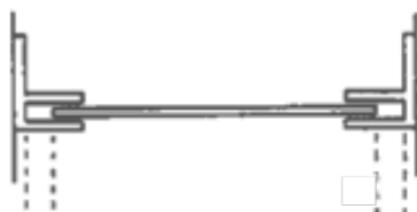
Placez les panneaux de soffite dans les moulures et clouez chaque panneau dans le vieux soffite ou dans toute autre charpente de bois située sur le mur de la maison. Enclenchez les panneaux suivants et clouez-les. Pour tout panneau de plus de 500 mm (20") de long, il est nécessaire de clouer également au centre du panneau.
