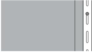
Fixer au niveau de la fente de clouage la plus haute et la plus dégagée du panneau, vers le haut du mur. NE PAS fixer à travers les brides de clouage de tout autre accessoire.
