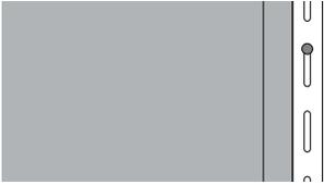
Fixer au niveau de la fente de clouage la plus haute et la plus dégagée du panneau, vers le haut du mur. NE PAS fixer à travers les brides de clouage ou de tout autre accessoire.
