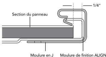
SECTION À BAGUETTE – NE PAS utiliser la moulure de finition
