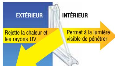
Le coefficient « R » indique la résistance rencontrée par le flux thermique face à un objet solide. Plus le coefficient R est élevé, meilleur est le rendement isolant quant aux pertes de chauffage et de refroidissement!
