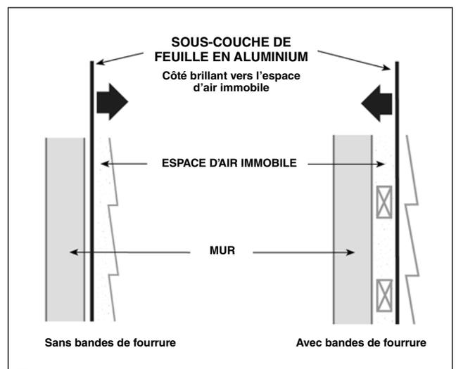
**IMPORTANT :** Évaluez les murs avant l'installation pour vous assurer qu'ils sont complètement plats en utilisant la méthode de votre choix (c.-à-d. niveau laser, fil à plomb, etc.). Si la surface du mur n'est pas une base lisse et régulière avant l'installation, il y a risque de gondolage.
