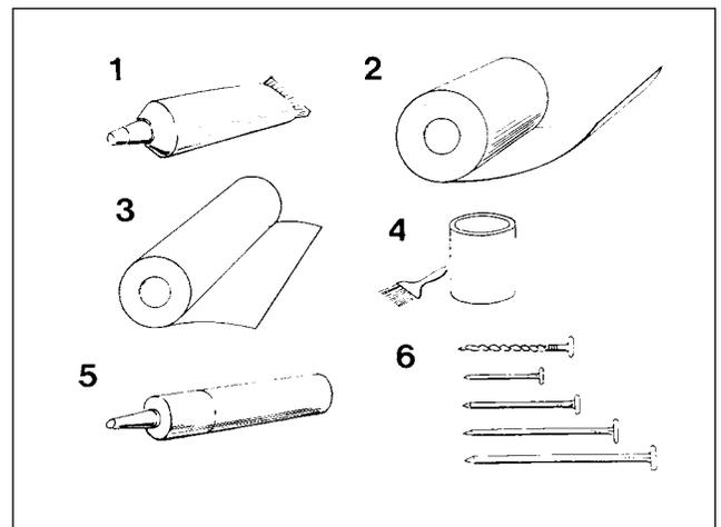
**Remarque :** Une pénétration minimale de 3/4", excluant la pointe du clou, dans le bois massif est nécessaire pour un clouage efficace avec des clous à tige unie. Les clous annelés ou à tige de vis peuvent être utilisés dans un contre-plaqué de 1/2" pour une même efficacité.
