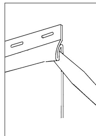
Les cisailles de type bec-de-canard sont idéales pour couper les accessoires comme la moulure de finition à enclenchement, la moulure en J et la bande de départ. Utilisez une scie à métaux pour couper des accessoires comme les poteaux corniers.
