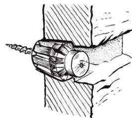
Les panneaux **NorthRidge Stone** arrivent prêts à être fixés grâce à notre système d'insertions auto-dissimulées et auto-scellantes.
